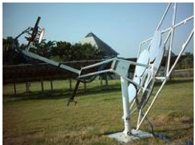
ภาพที่ 1 ระบบทั้งหมดที่ประกอบด้วย จานพาราโบลา 5 ใบ, อุปกรณ์ติดตามดวงอาทิตย์ และ อุปกรณ์ดูดซับความร้อนที่จุดรวมแสง
