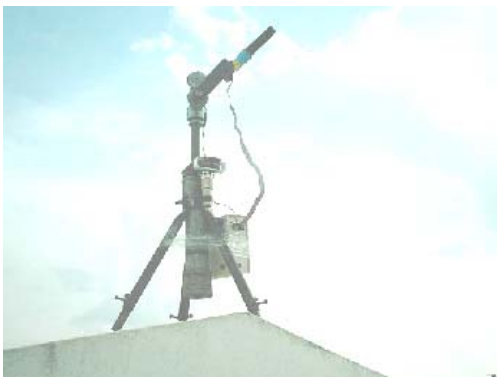
รูปที่ 11 แสดงภาพขณะทดสอบเครื่องติดตามดวงอาทิตย์
