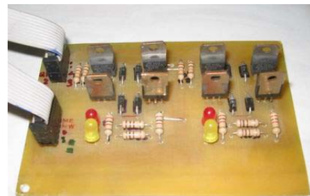
รูปที่ 6 แผงวงจรขับเคลื่อนมอเตอร์เครื่องติดตามดวงอาทิตย์
