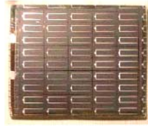
รูปที่ 4 เซลล์แสงอาทิตย์ชนิดฟิล์มบาง CIGS ประกอบด้วยเซลล์ย่อยพื้นที่ 0.5x1.0 ตร.ซม. ประมาณ 40 เซลล์
