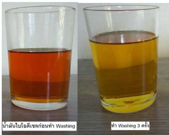
รูปที่ 5 สีของน้ำมันไบโอดีเซลที่ผลิตได้จากเครื่องต้นแบบก่อนและหลังทำ Washing
