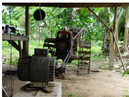
รูปที่ 1 การประยุกต์ใช้เครื่องยนต์การเกษตรเพื่อการผลิตกระแสไฟฟ้า
