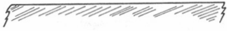
รูปที่ 1 ผิวหน้าชิ้นงานดูเรียบเมื่อมองด้วยตาเปล่า
