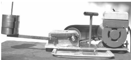
รูปที่ 11 การทดสอบขณะไม่มีน้ำมันเครื่อง
