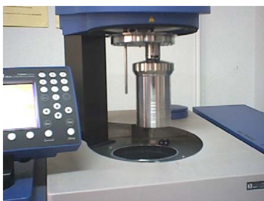
รูปที่3 แสดงการใช้งาน Calorimeter Bomb ในการวิเคราะห์ค่าคุณสมบัติเบื้องต้นของวัสดุเชื้อเพลิง
