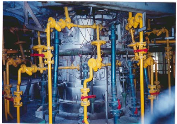
รูปที่ 1 ก เตาหลอมทองแดงที่ใช้ในงานวิจัย
