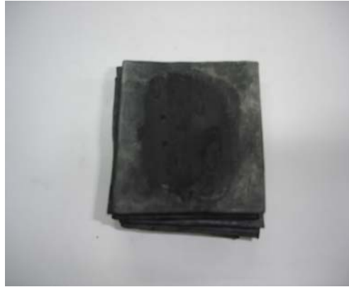
รูปที่ 10 ชิ้นงานหลังนำออกจากแม่พิมพ์เมื่อให้ความร้อนแก่ชิ้นยางด้วยคลื่นไมโครเวฟ
