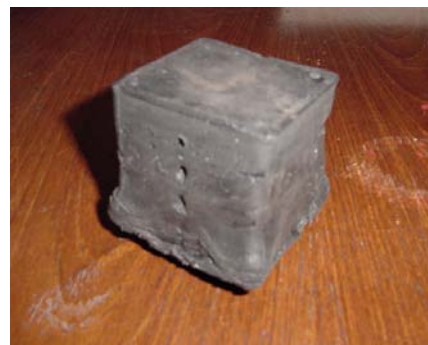
รูปที่ 8 ชิ้นงานหลังนำออกจากแม่พิมพ์เมื่อให้ความร้อนแก่ชิ้นยางโดยใช้แผ่นเหล็กร้อน
