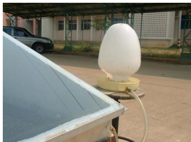
รูปที่ 4 ส่วนควบคุมระดับน้ำทำด้วยถังพลาสติกให้น้ำสั้ว ขนาดประมาณ 6 ลิตร
