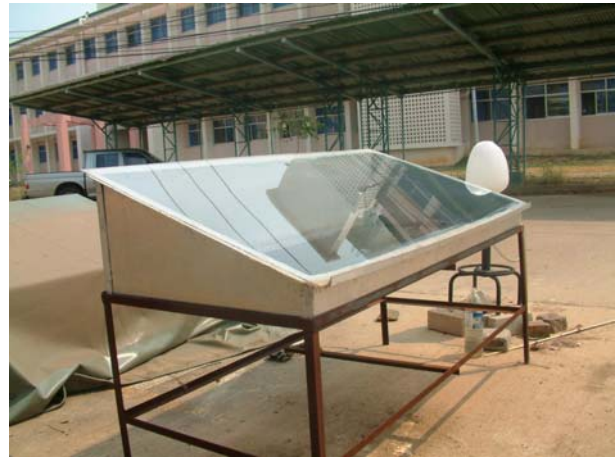
รูปที่ 2 ตัวเครื่องกลั่นเมื่อเสร็จ ปิดด้วยกระจกใสเอียงทำมุม 20 องศา กับแนวระดับ
