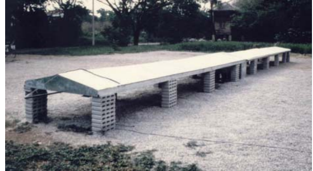
รูปที่ 2 แสดงเครื่องอบแห้งแบบอุโมงค์ลมที่ติดตั้ง gas burner [2]
