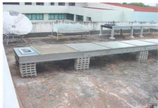
รูปที่ 3 แสดงเครื่องอบแห้งแบบอุโมงค์ลมที่ใช้แผ่นโพลีคาร์บอเนต ปิดด้านบน
