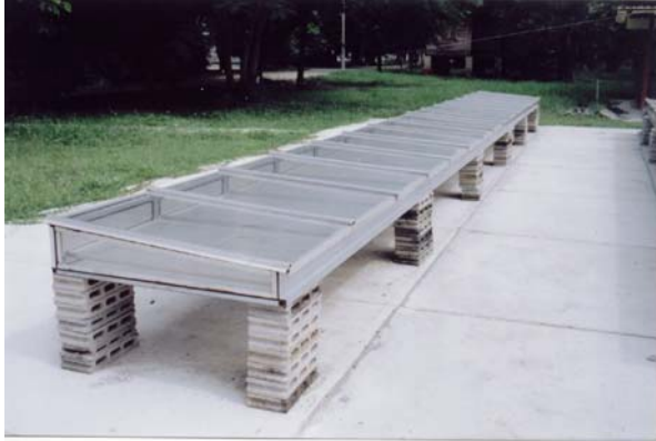
รูปที่ 4 เครื่องอบแห้งแบบอุโมงค์ลมที่ใช้กระจกปิดด้านบน
