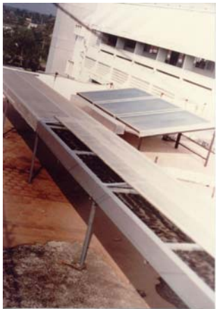
รูปที่ 1 แสดงเครื่องอบแห้งแบบอุโมงค์ลมที่มีโครงสร้างเป็นไม้ ซึ่ง พัฒนาในปี พ.ศ. 2535 [1]
