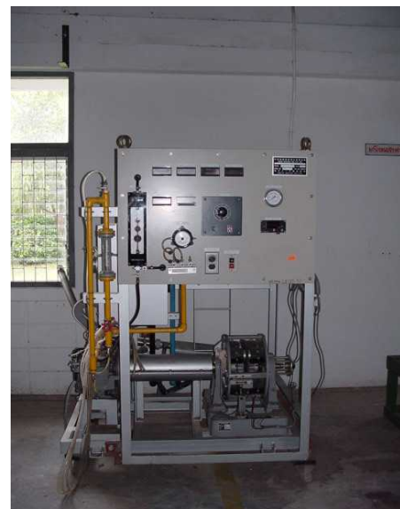
รูปที่ 2 ชุดทดสอบสมรรถนะของเครื่องยนต์แบบ EDDY CURRENT TEST BED
