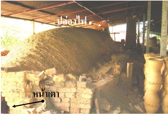
รูปที่ 1 แสดงภาพของเตาเผาเครื่องปั้นดินเผาแบบตัวหนอน ที่ใช้กันทั่วไปที่บ้านปากห้วยวังนอง อ.เมือง จ.อุบลราชธานี
