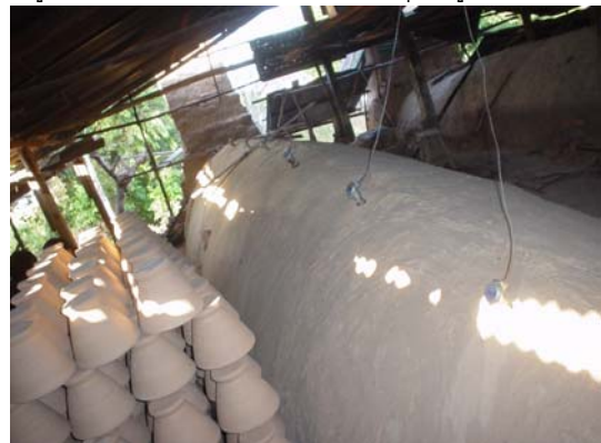
รูปที่ 3 แสดงตัวอย่างการติดตั้งหัววัดอุณหภูมิบนเตาเผา
